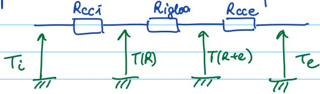
Etablissons les résistances thermiques équivalentes aux phénomènes de conducto-convection.
